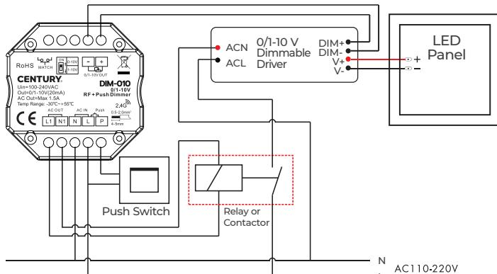
Collegamento con driver dimmer 0/1-10V (usare AC OUT e relè o contattore)
