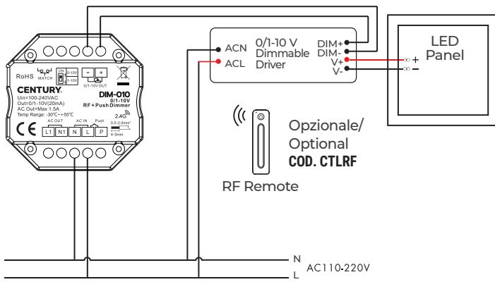
Collegamento con driver dimmer 0/1-10V (senza usare AC OUT)
