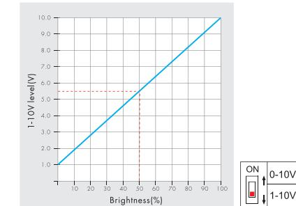
Selezionare il dimmer 0-10V o il dimmer 1-10V in base al driver LED dimmerabile.
